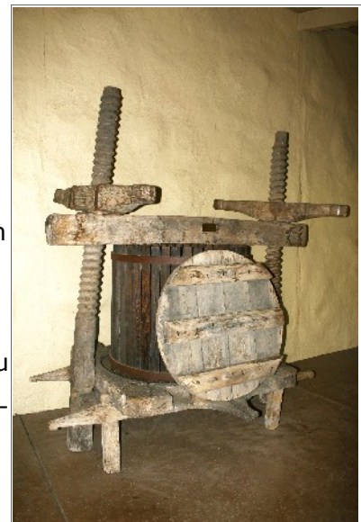
Korbpresse, 16. Jahrhundert. Die Technologie ist (modifiziert) zum Teil heute noch verbreitet.
