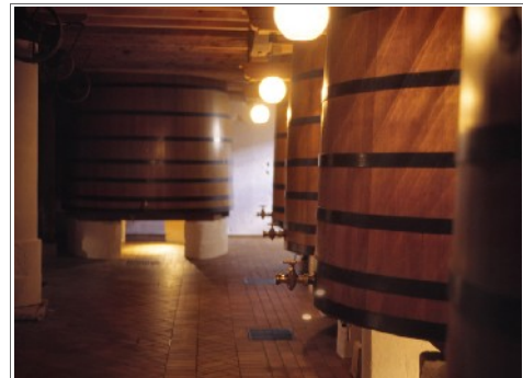
Holzbottiche (franz. cuves) sind traditionelle Gärbehälter bei der Rotweinerstellung.
